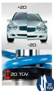
Kein Fahrzeug ist wie das andere. Und auch jeder Fahrstil ist einmalig. Deshalb können Sie bei unseren Gewindefahrwerken auch im eingebauten Zustand die Fahrzeughöhe verändern.
