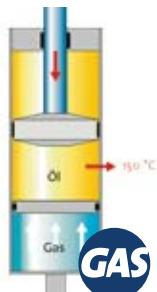
Die von BILSTEIN entwickelte Einrohr-Gasdrucktechnik hat sich mittlerweile als ein Standard im Automobilbau etabliert. Das Öl im Dämpfer steht hier unter Druck, so dass bei steigenden Temperaturen und Belastungen ein Aufschäumen des Öls verhindert wird. Dadurch stehen auch bei hoher Beanspruchung die vollen Dämpfkräfte zur Verfügung. Zu erkennen an der selbstausfahrenden Kolbenstange.
